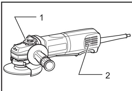
► 1. Salida de ventilación 2. Entrada de ventilación
